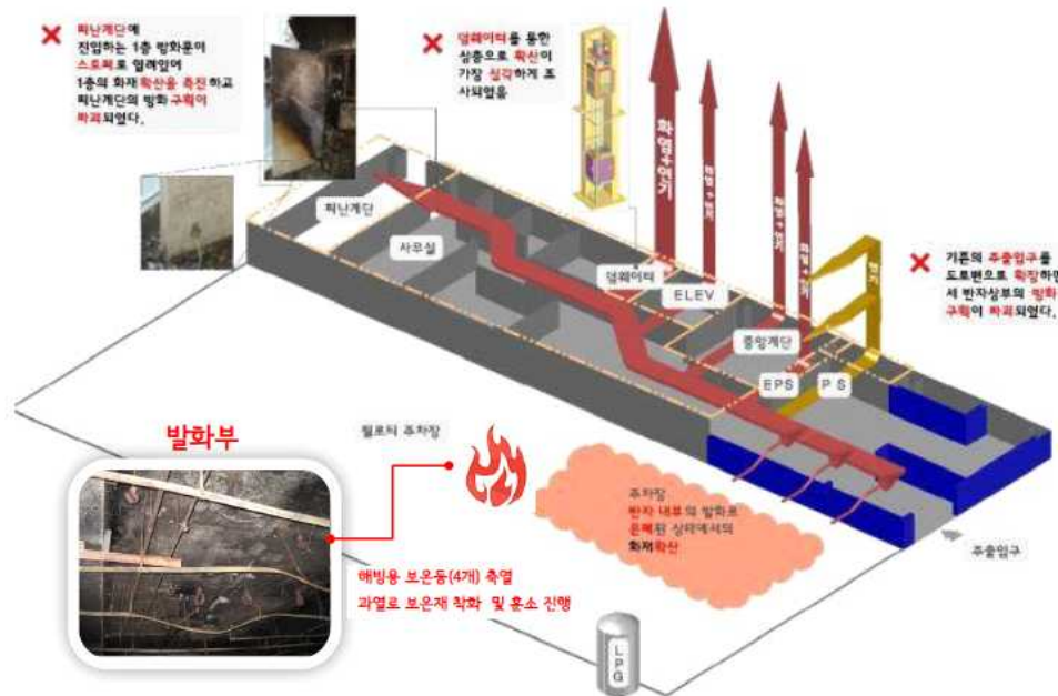
<그림 4.6> 건물 내부 수평 및 수직 연소확산 경로
